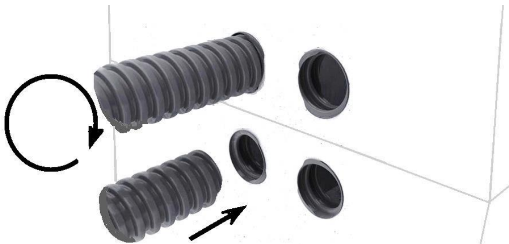
Рис. 11. Ввод труб «КСС-ПГТ» 125 мм в колодец «ККС 2,5-10 ГЕК КСС-ПГТ» с вмонтированными в стены соединительными муфтами.
