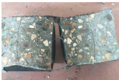
Рис.8. Глубина проникновения воды при давлении 1,4 МПа на исследуемый бетонный кубик
